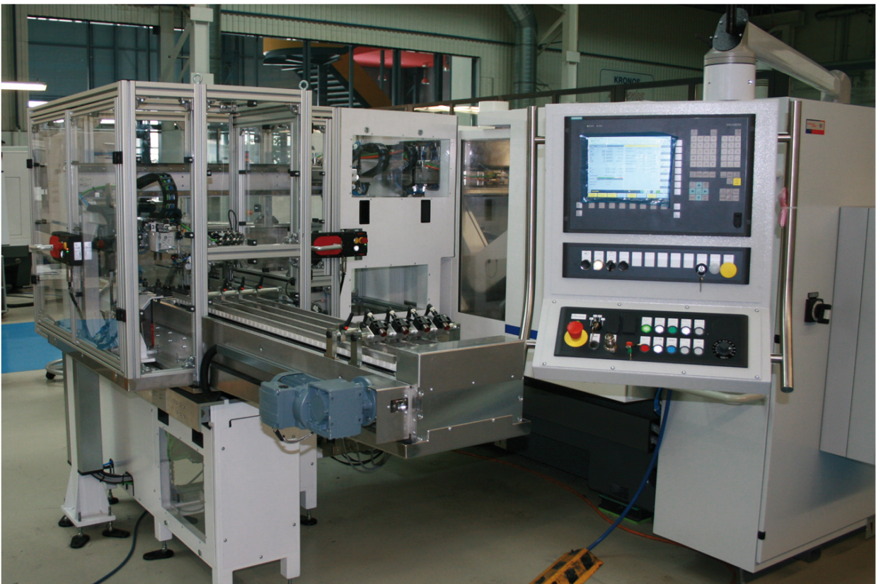
Abb. 13.216: Maschine mit seitlich einfahrendem Portal und Taktspeicherbändern (Quelle: Schaudt Mikrosa GmbH)
