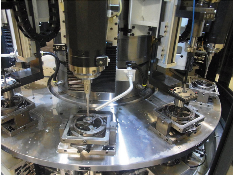
Abb. 111 Rundtisch-Honmaschine (Quelle: Kadia)
